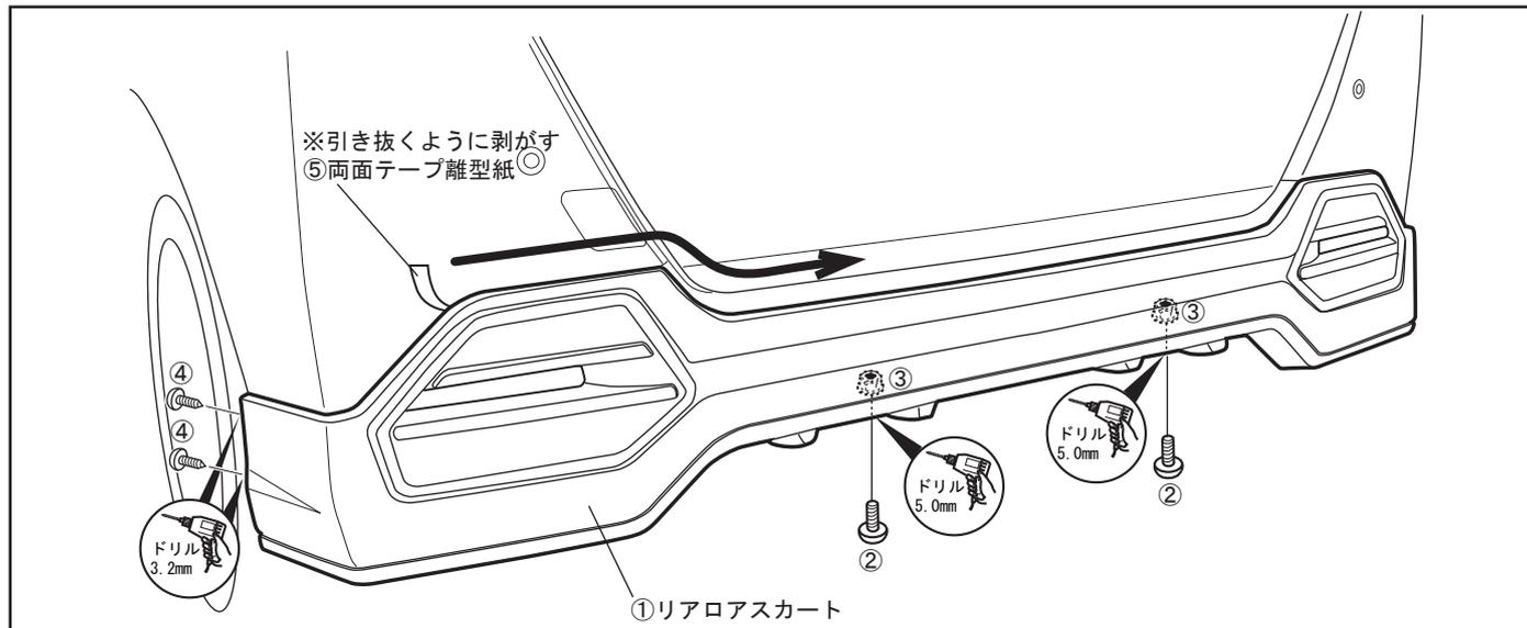
1. 図を参照して、①リアアスカーを車両にセットして取付位置を確認してください。車両リアバンパーアッパー/ロアの合わせ目に①リアアスカーをセットする。
