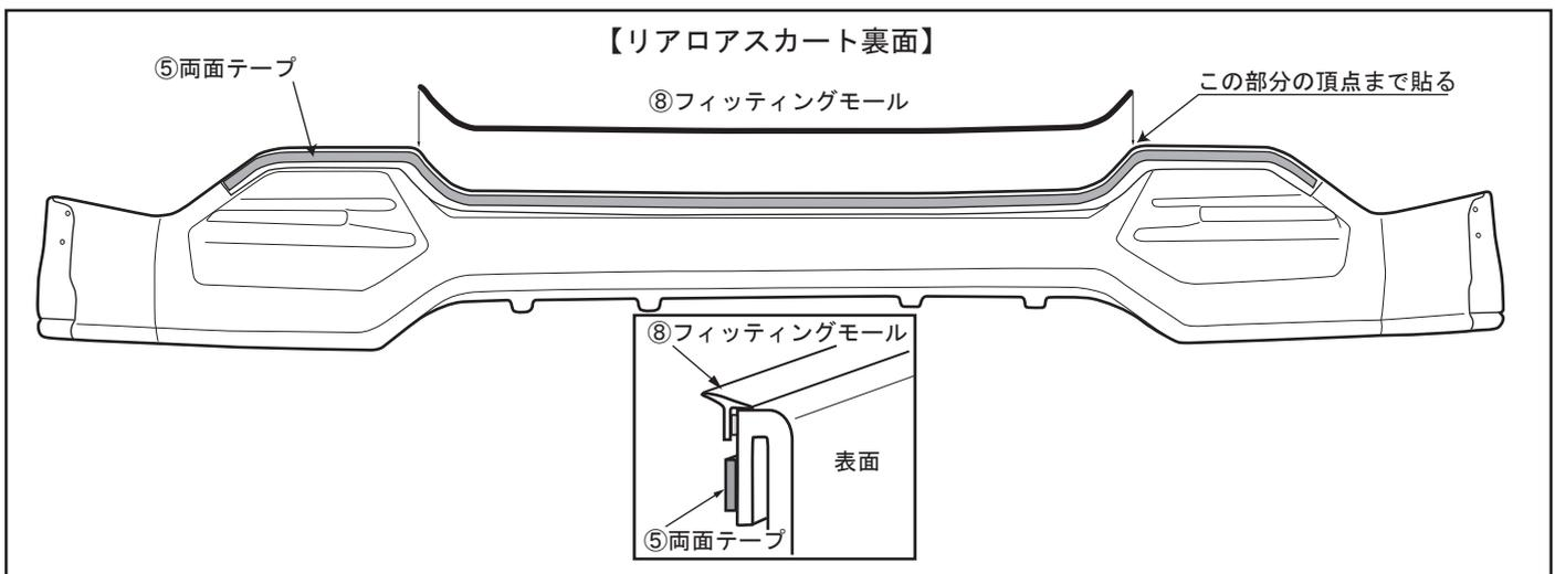
1. 図を参照して、①リアロアスカートの裏面、車両取付面をきれいに清掃して、脂分を十分に脱脂してください。
