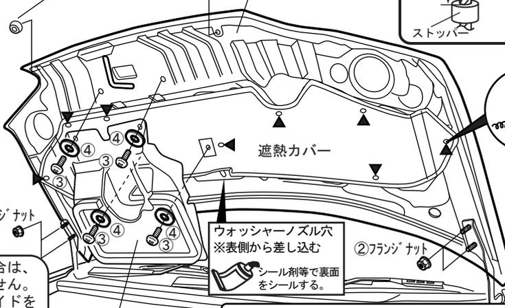
●3気筒ターボ車に取付ける場合は、純正エアガイドが装着できません。4気筒ターボ車用純正エアガイドを購入して取付けてください。(品番76109-B030-000)
