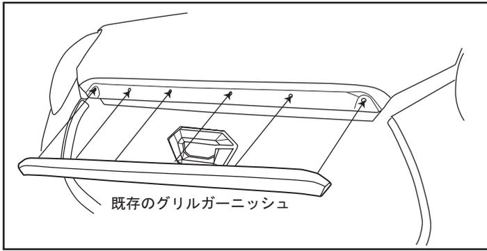
5. 図を参考にして、①ボンネットを閉じて、①ボンネットの穴位置に合わせて既存のグリルガーニッシュを取り付けてください。
