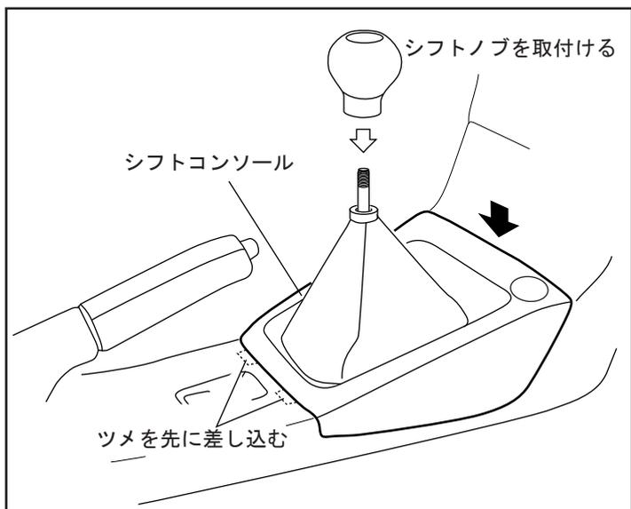
(4) 裏返しにしていた①シフトブーツを元に戻してシフトコンソールをシフトレバーに通して、後側のツメを差し込み、はめ込んでください。
