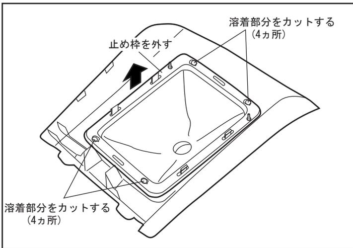
(3) シフトコンソール裏面のブーツの止め枠を溶着部分 (4カ所) をカットして取外して、ブーツをシフトコンソールから取外してください。
