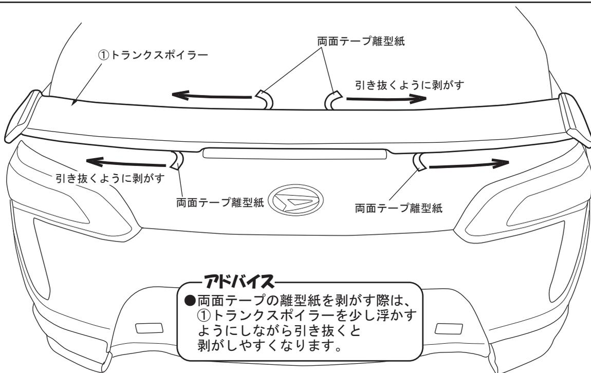
4. 図を参考にして、両面テープの離型紙を引き抜くように剥がして、①トランクスポイラー本体を車両に十分に圧着してください。
