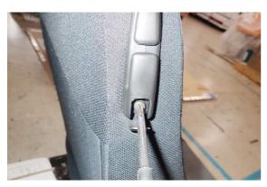
2 プラスドライバーを使用し、ネジを外します。
