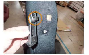
3 シートベルトガイドを下方向にスライドさせると、図の○位置のツメが外れ、取り外す事が出来ます。
