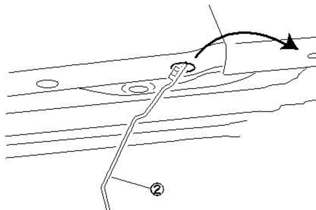
2. フロアー強化バー本体を車体に合わせ 1. で差し込んだナット付プレートと付属のネジ類を用いて車体へ取付けします。
