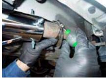
クリッパーを最適な位置に4点の取付ボルトを締めて固定
